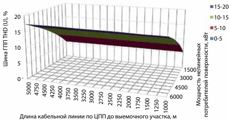
Рис. 3. Результаты моделирования (THD(U)_{гпп} = f(P_{н.п.п.}, L_{кв.ву.})) Fig. 3. Simulation results (THD(U)_{гпп} = f(P_{н.п.п.}, L_{кв.ву.}))
