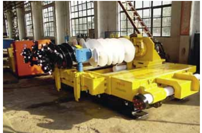
Рис. 8. Бурошнековый комплекс в классическом исполнении (Китай)
