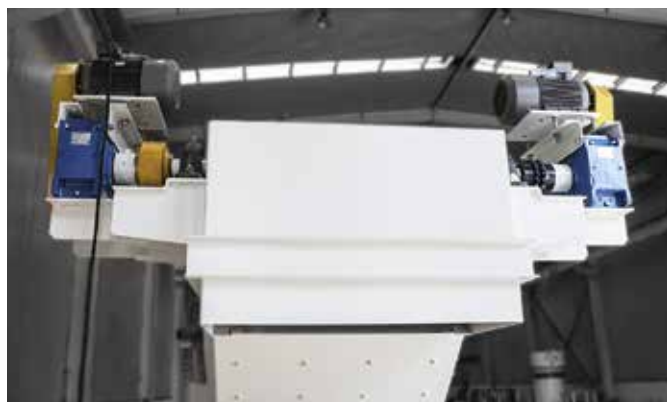
Привод с запасом прочности. Опционально-резервный привод
