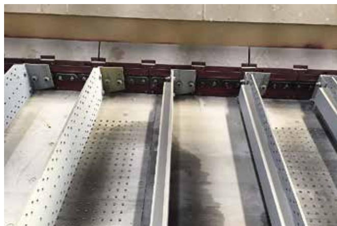
В типовом режиме скребки и цепь меняют за ~4 часа, как правило, раз в 6 месяцев
