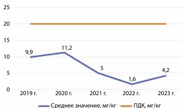
Рис. 2. Среднее содержание валового фтора в растительности СЗЗ разреза «Черногорский»
