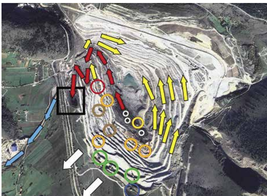
Рис. 2. Схема расстановки экскаваторов и логистики карьерных грузопотоков в карьере по добыче угля в окрестностях г. Плевля на территории Черногории (на снимке из космоса)
