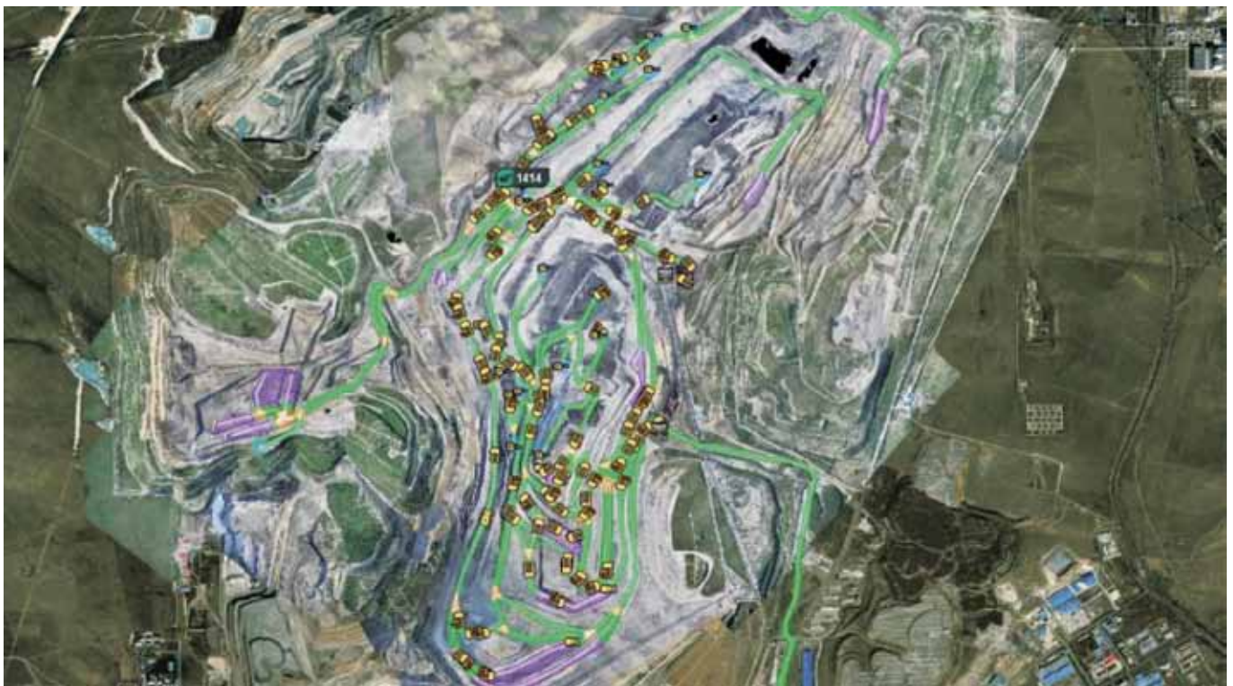
Рис. 2. Схема заторов на перекрестках технологических трасс Fig. 2. Scheme of congestion at the intersections of technological routes
