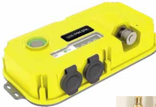
Рис. 4. Измерительный прибор VoD-305 (Австралия) – а; измеритель микросекундных интервалов времени ИВИ-4 (КТБ «Интервал», г. Новосибирск) – б
