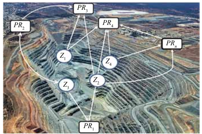
Рис. 1. Схема расположений и варианты транспортировки горной массы от ( Z_n – забоев) до ( PR_n – пунктов разгрузки) Fig. 1. A layout and options for transportation of rock mass from ( Z_n – faces) to ( PR_n – unloading stations)
