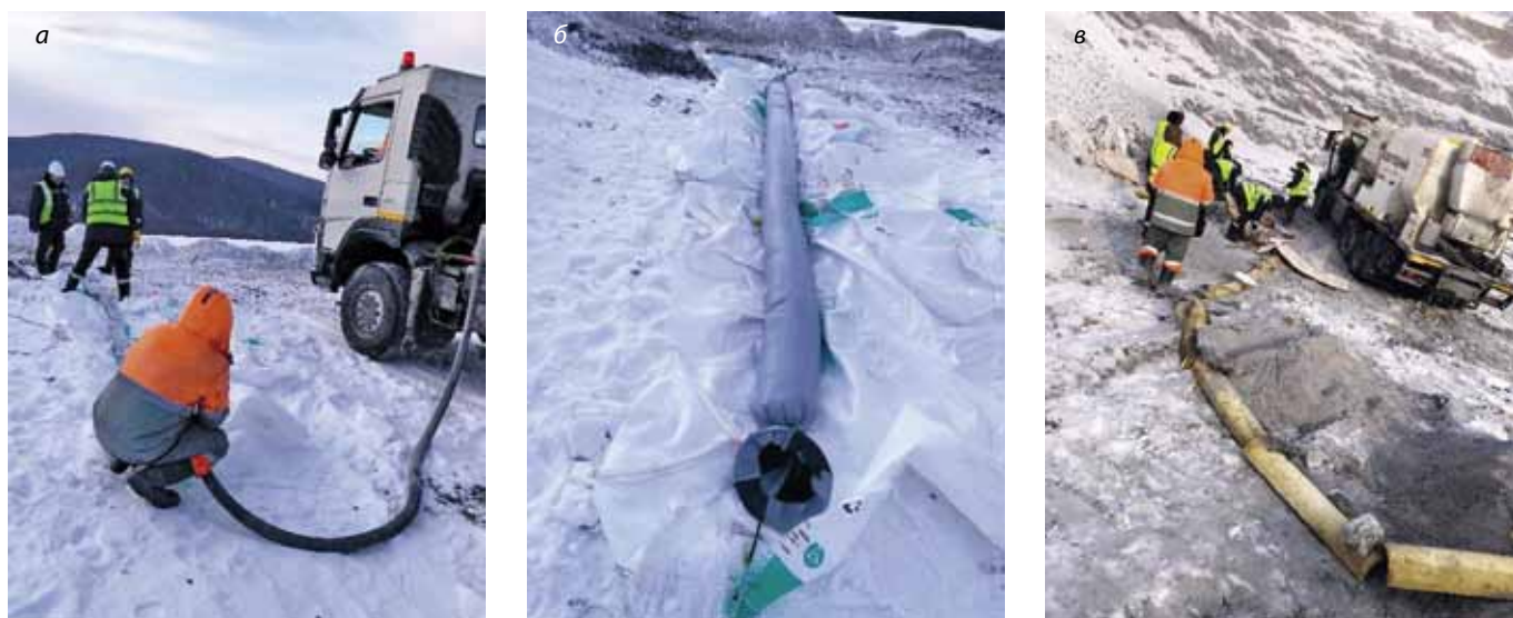
Рис. 1. Процесс формирования заряда ЭВВ и монтаж измерительного кабеля при испытании: а, б – на полигоне в полиэтиленовом рукаве, L – 6 м; в – в технологических скважинах на взрывном блоке Fig. 1. The process of emulsion explosive charge formation and installation of the measuring cable during testing: а, б – at the test site in a polyethylene sleeve, L – 6 m; в – in a technological borehole drilled in the blast block
