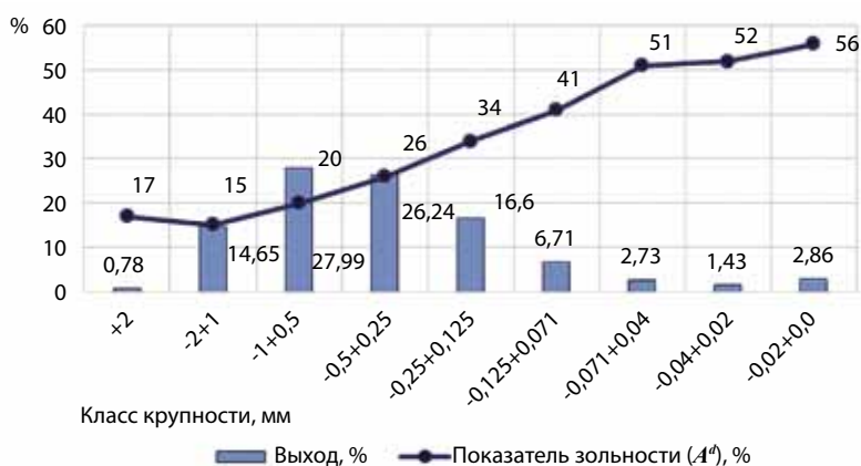
Рис. 1. Гранулометрический анализ исходных шламов КНС «Краснобродский угольный разрез» с показателями зольности сухого топлива в каждом классе крупности
