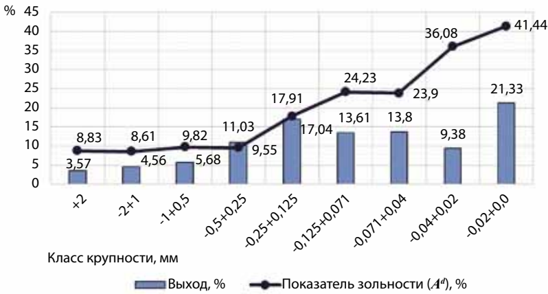
Рис. 2. Гранулометрический анализ исходных шламов КНС «Кедровский угольный разрез» с показателями зольности сухого топлива в каждом классе крупности
