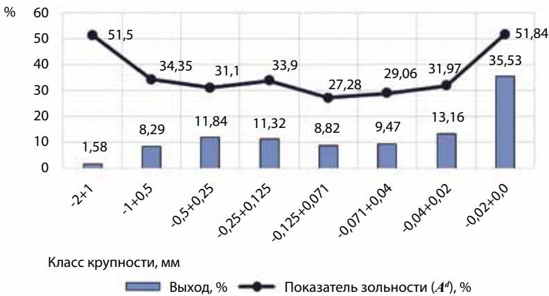
Рис. 3. Гранулометрический анализ исходных шламов КНС пробы № 2 (кек) «Бачатский угольный разрез» с показателями зольности сухого топлива в каждом классе крупности
