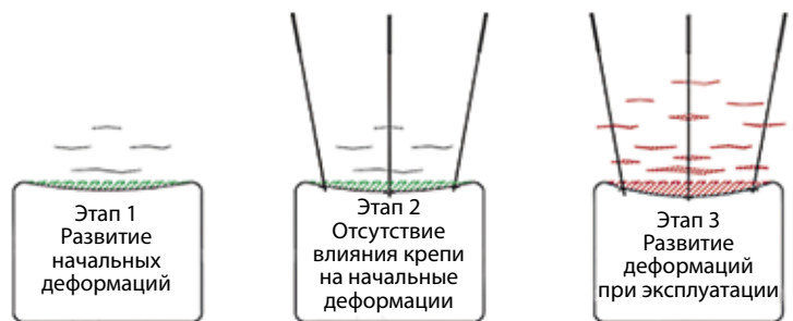
Рис. 4. Динамика конвергенции выработки и взаимодействие крепи с приконтурным массивом при креплении податливой анкерной крепью
