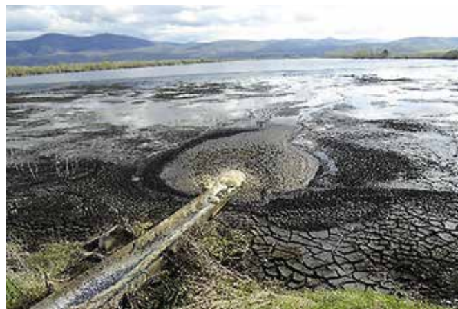
Рис. 1. Внешний вид хвостов углеобогащения (кек) Тугнуйской ОФ и шламовых карт с отходами Селенгинского ЦКК (лигнин) Fig 1. Visual appearance of the coal washing tailings (cakes) from Tugnuyskaya Processing Plant and sludge maps with the waste from the Selenginsky Pulp and Paper Mill (lignine)
