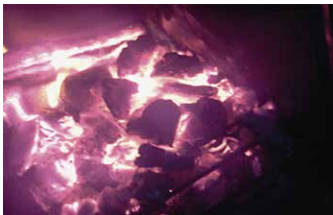
Рис. 6. Сохранение формы сжигаемых брикетов при температуре 1000°C в течение 20-25 мин
