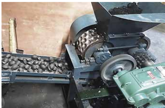
Рис. 4. Производство топливных брикетов, состоящих из хвостов углеобогащения (кек) и гидролизованного лигнина (связующее) с помощью валкового пресса Fig. 4. Production of fuel pellets consisting of the coal washing tailings (cake) and hydrolyzed lignin (binder) using a roller press
