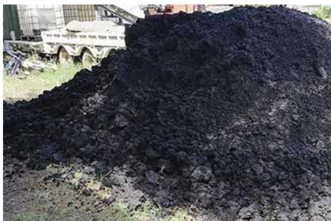
Рис. 1. Внешний вид хвостов углеобогащения (кек) Тугнуйской ОФ и шламовых карт с отходами Селенгинского ЦКК (лигнин) Fig 1. Visual appearance of the coal washing tailings (cakes) from Tugnuyskaya Processing Plant and sludge maps with the waste from the Selenginsky Pulp and Paper Mill (lignine)
